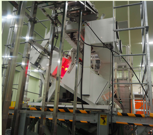
右：カラーソーター 下：NG品 (これくらいの焦げでも、製品としてはNGとしている)
